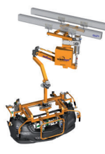
ELSŐ LÖKHÁRÍTÓ BEÉPÍTÉSE
